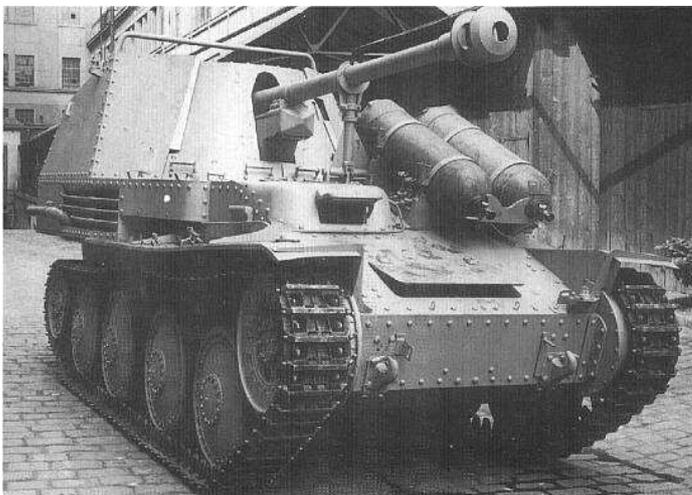
*Panzerjäger 38(t) für 7,5 cm Pak 40/3 Ausf. M Sd Kfz 138 „Marder“ III wyposażony w napęd gazowy. Na przednim panczerze widoczne dwie butle z gazem. zakłady BMW w Pradze. Panzerjäger 38(t) für 7,5 cm Pak 40/3 Ausf. M Sd Kfz 138 „Marder“ III gazopędowy SP gen. BMW factory, Praga. [Dokumentacja ŚKD]*
