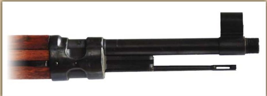
Левосторонняя резьба на дульной внешней части ствола винтовки обр. 1953 г. для навинчивания глушителя или пламегасителя
