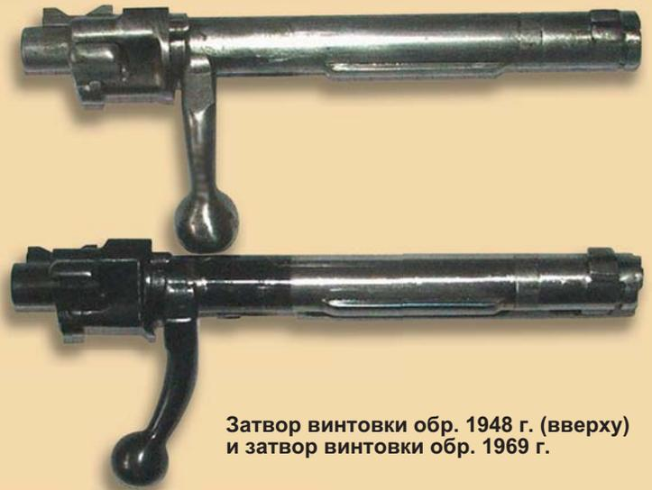
Затвор винтовки обр. 1948 г. (вверху) и затвор винтовки обр. 1969 г.
