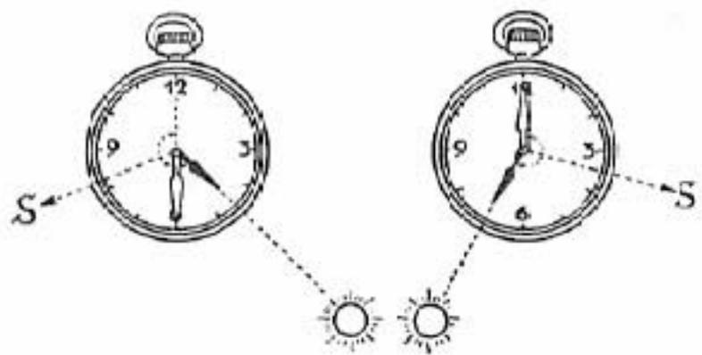
Bild 6. Feststellen der Südrichtung mit der Taschenuhr
