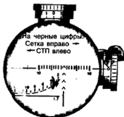
Схема 24. Боковые поправки на ПСО-1. Средняя точка попаданий (СТП) всегда уходит в сторону, противоположную перемещению прицельной сетки
