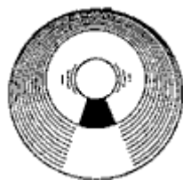
Расположение тени в непогнутом гладком стволе
