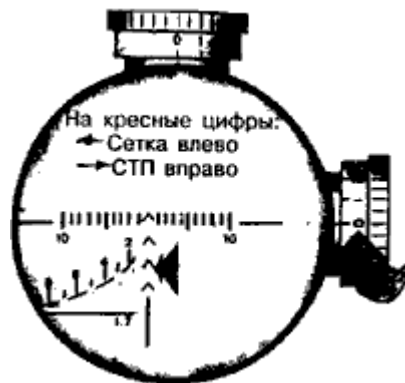
Схема 23. Боковые поправки на ПСО-1. Средняя точка попадания (СТП) всегда уходит в сторону, противоположную перемещению прицельной сетки
