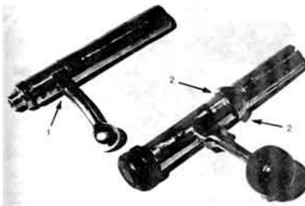
Фото 86. Затворы малокалиберных винтовок: 1 - ТОЗ-8 ТОЗ-12; 2 - "Биатлон-6". Видно два боевых выступа из трех
