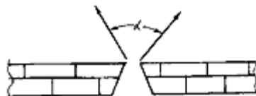
Схема 106. Амбатура "обратный раструб"; \alpha - сектор обстрела
