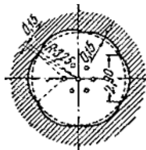
Схема 138. Нарезы 6,5-мм винтовки системы Арисака
