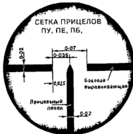
Схема 16. Прицельные нити прицелов ПУ, ПЕ, ПБ: Проекция угловых величин прицельных нитей в тысячных
