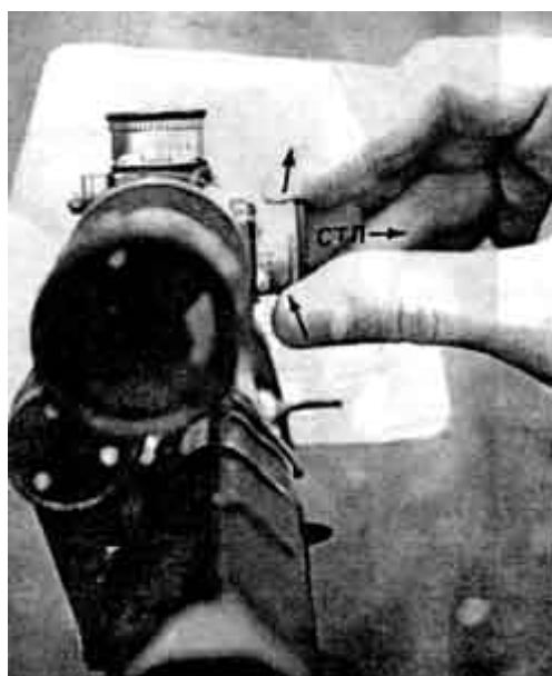
Фото 101. Если крутить боковой маховик прицела ПСО-1 по часовой стрелке, пули (средняя точка попадания) уходят вправо "в ладонь"
