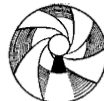
Расположение тени в непогнутом нарезном стволе
