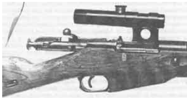
Фото 31. Изогнутая рукоятка затвора не задевает за оптический прицел. Магазин наполняется нажатием патрона сверху вниз. На снимке виден патрон, удерживаемый от выпадения вверх лопастью отсечки-отражателя
