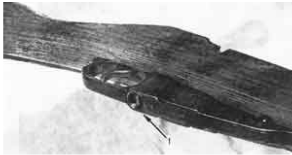
Фото 13. Неполная разборка. Подать назад защелку магазинной коробки (1)
