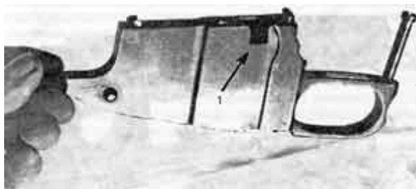
Фото 27. Магази́нная коробка: 1 - вырез для отсекающего зуба пружины отсечки-отражателя
