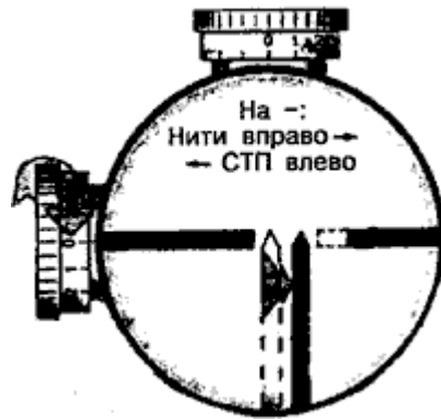
Схема 22. Боковые поправки на ПУ. ПЕ, ПБ. Средняя точка попадания (СТП) всегда уходит в сторону, противоположную перемещению прицельных нитей
