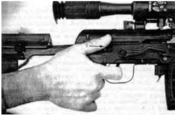
Фото 135. Боковой хват pistolетной рукоятки. Большой палец можно положить на рычаг фиксатора крышки ствольной коробки - 1
