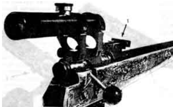
Фото 88. Крепление оптического прицела на винтовке БИ-6. "Окна" парного кронштейна позволяют прицеливаться открытым прицелом 1
