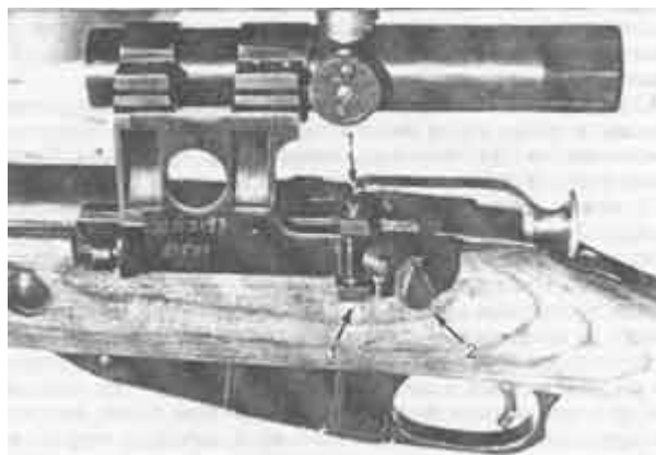
Фото 32. Постановка оптического прицела ПУ: 1 - винты /вертикальной регулировки; 2 - запирающий винт (затянут)
