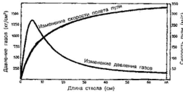
Схема 112. Изменение давления газов и скорости пули в стволе малокалиберной винтовки
