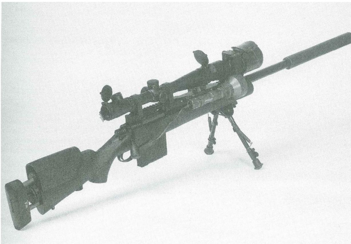
Обновленная винтовка Remington M24A2 имеет новую регулируемую ложу, съемный магазин и глушитель в качестве опции.
