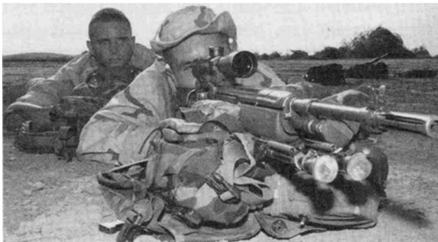
Винтовка для назначенных метких стрелков морской пехоты США (DMR) является винтовкой M14 с очень высокой точностью, с установленным здесь прицелом Unertl 10x.
