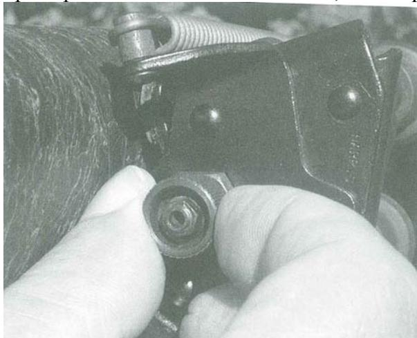
Поверните этот винт с насечкой, чтобы отрегулировать степень зажатия опоры этой сошки серии L фирмы Harris.
