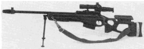
Русская винтовка СВ-98 с продольно-скользящим затвором заменяет винтовку СВД. Несмотря на то, что она имеет сходство с винтовкой АW, она имеет полностью другую конструкцию. (Фото предоставлено Оружейным клубом Валерия Шилина).
