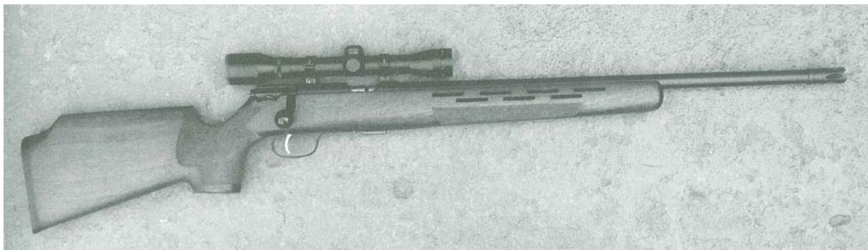
Превосходная учебная винтовка Krico Super Sniper .22 калибра с тяжелым стволом, целевым спусковым механизмом и щелевым пламегасителем.
