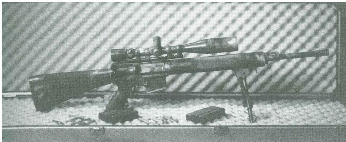
Эта винтовка AR-15, переделанная компанией D&L Sports, отличается свободно вывешенным матчевым стволом, матчевым ударно-спусковым механизмом и низко установленной базой под оптический прицел.
