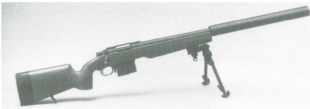
В винтовке McMillan M89 используются фиксированный, устанавливаемый в заводских условиях, компактный ПБС весом 15 унций. Винтовка имеется только в калибре 7,62-мм/.308, и с магазинами на 5, 10, и 20 патронов.
