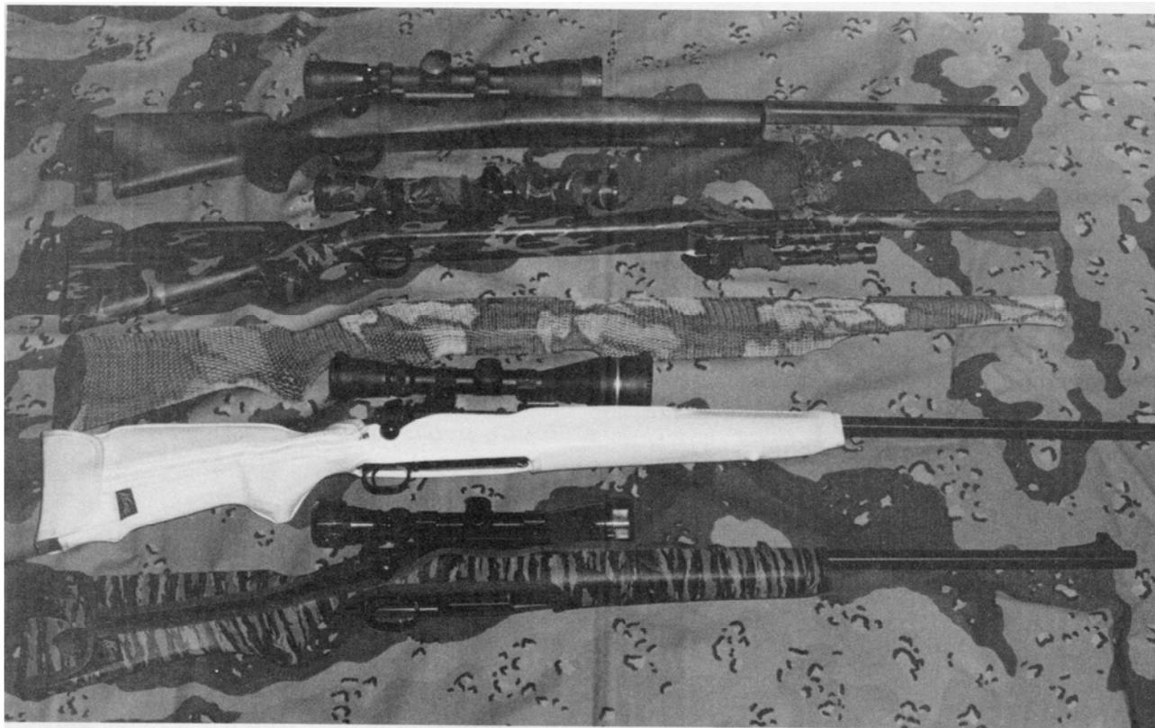
МАСКИРОВКА ОРУЖИЯ (сверху вниз): окрашенная винтовка M24; обмотанная винтовка Remington 700 автора; носок Spandoflage на пистолете; белый чехол-чапс на винтовке Winchester 70; чехол Realtree на левой винтовке Sako, принадлежащей автору.
