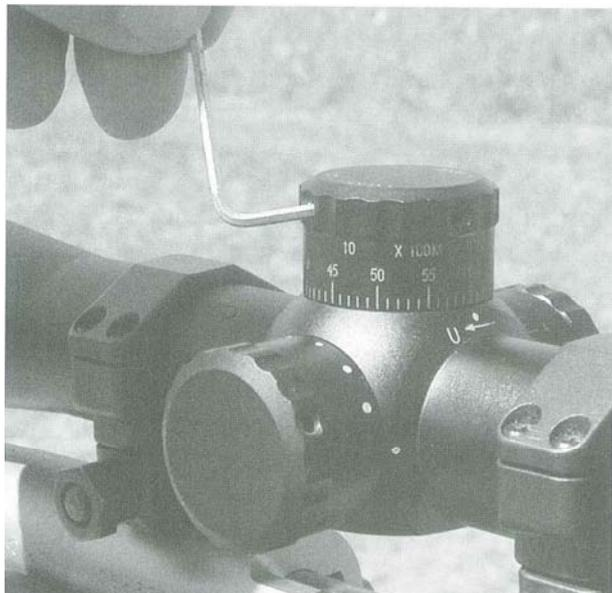
Заключительный шаг пристрелки с КСТП — ослабить винты барабанчика КСТП, выровнять значение дистанции пристрелки и затянуть винты с головкой под внутренний шестигранник.
