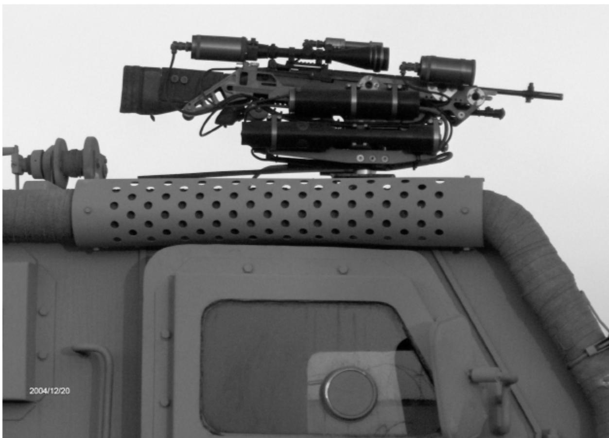
Снайперская винтовка, установленная на крыше броневедомобиля «Кугуар». Система TRAP 250 также может совмещаться или устанавливаться на стандартный пулеметный станок-треногу.
