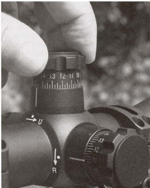
Барабанчики поправок, подобные этим, установленные на прицеле Leupold Mark 4, позволяют вносить очень точные поправки и производить точное прицеливание.
