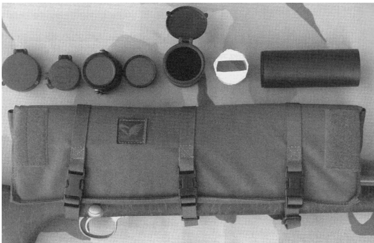
Принадлежности для прицела включают мягкий чехол фирмы Eagle и (слева направо): защитные колпачки для линз, поляризующие фильтры, сотовую бленду, крышку со щелью и коммерческую модель солнцезащитной бленды.
