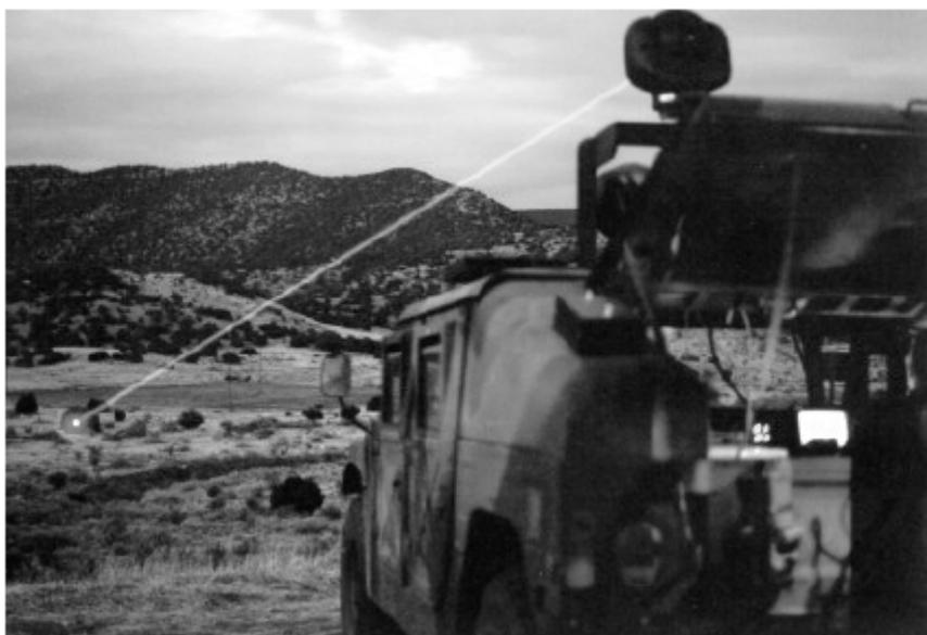
Система ВВС США BOSS (Battlefield Optical Surveillance System), мобильная контрснайперская система, в которой для обнаружения и «подсветки» вражеского снайпера используется лазер.
