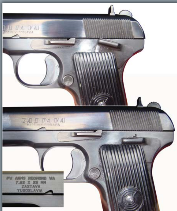
Неавтоматический предохранитель и надпись на пистолете 7,62 мм «PW Arms M-57 Zastava»
