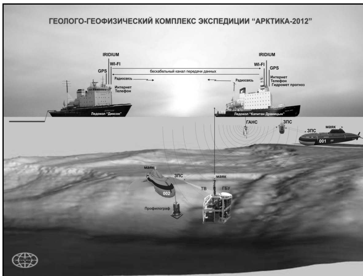
Рис. 1. Геолого-геофизический комплекс экспедиции «Арктика-2012» (ЗПС – звукоподводная связь, ГАНС – гидроакустическая навигационная система, ГБУ – глубоководная буровая установка)
