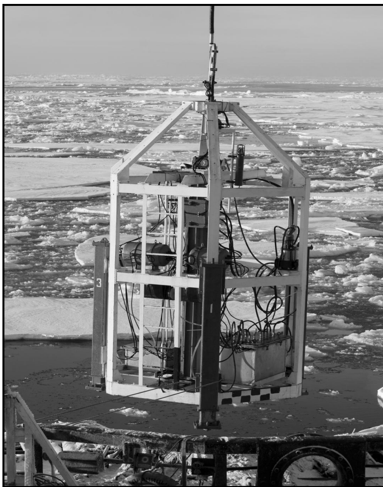
Рис. 3. Донный буровой станок ГБУ-2 (пр-во ОАО «Севморгео») при выведении его за корму ледокола для опускания на дно (красные штанги – выдвижные «ноги» системы горизонтирования станка на дне)
