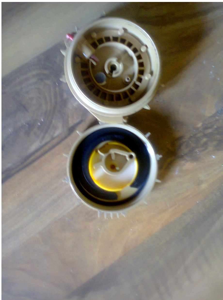
Фото изнутри итальянской противопехотной мины фугасного действия VS-50. Фото Найден Илиев
