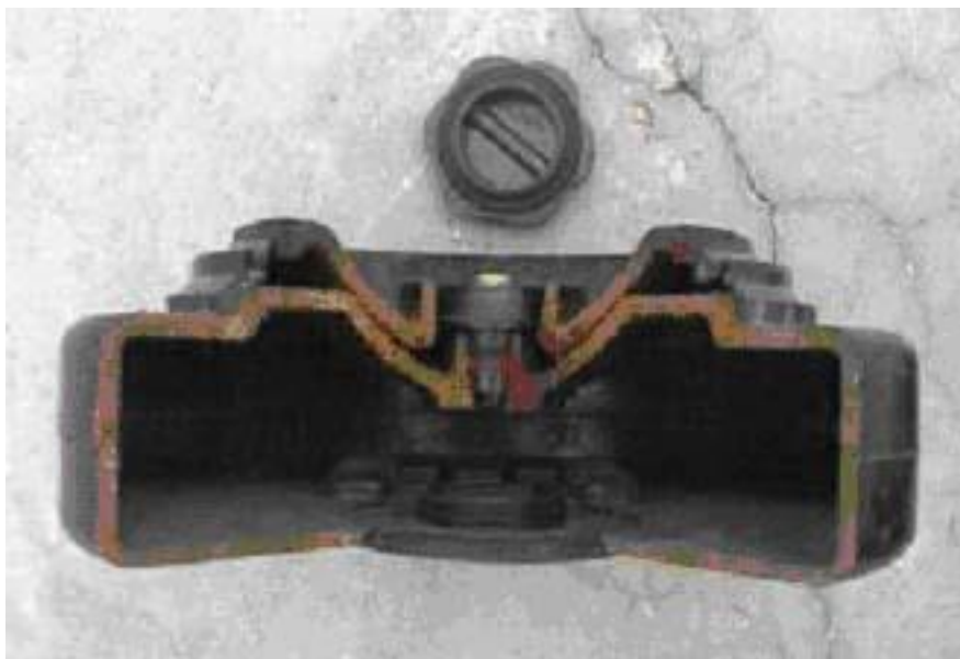
Противотанковая противогусеничная мина PT Mi –Ba-III производства бывшей Чехословакии. Фото с сайта Humanitarian Demining www.humanitarian-demining.com
