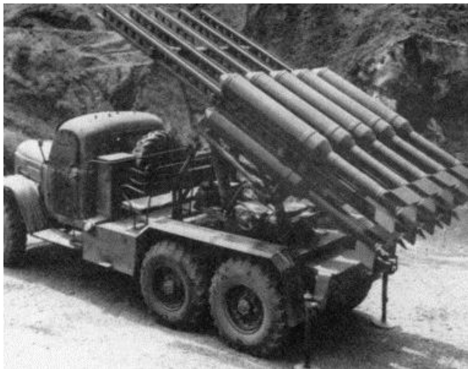
Китайская система дистанционного минирования Тип 74. Фото из справочника Jane's Mines and Mine Clearance 1999-00(Editor of Jane's Mines and Mine Clearance at Jane's Information Group Colin King).
