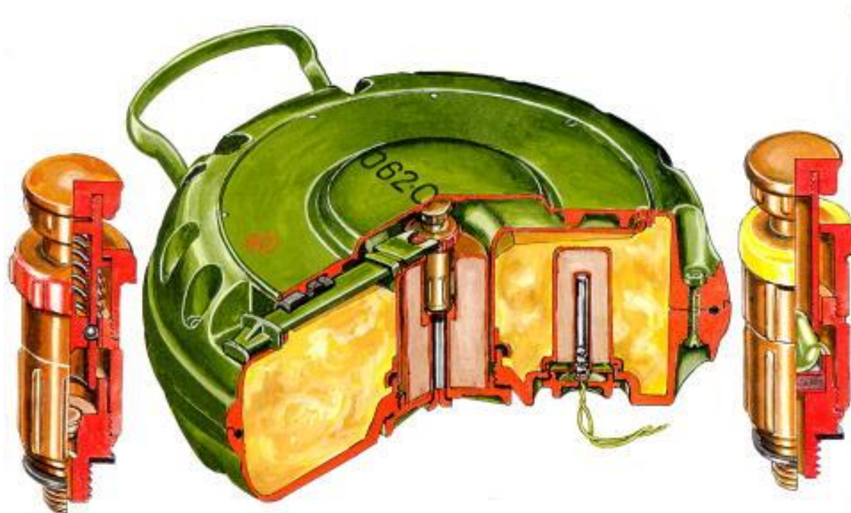
Разрез противотанковой противогусеничной мины ПМ-60(РМ-60).Рисунок из справочника Jane's Mines and Mine Clearance 1999-00(Editor of Jane's Mines and Mine Clearance at Jane's Information Group Colin King).Автор Lyn Haywood.
