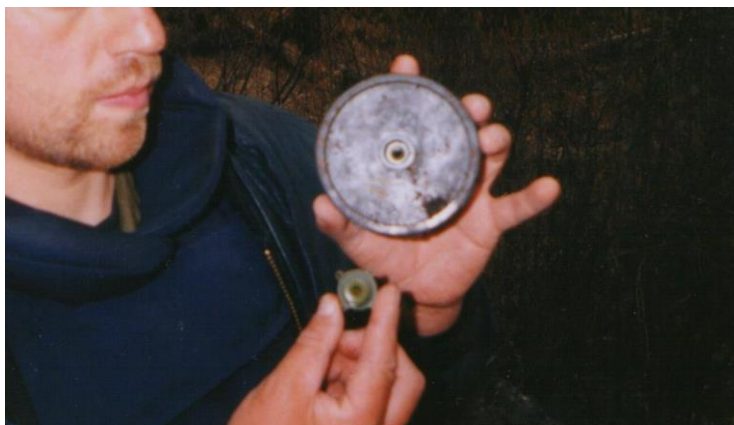
Установка взрывателя УПМАХ-3 в мину ПМА-3.
