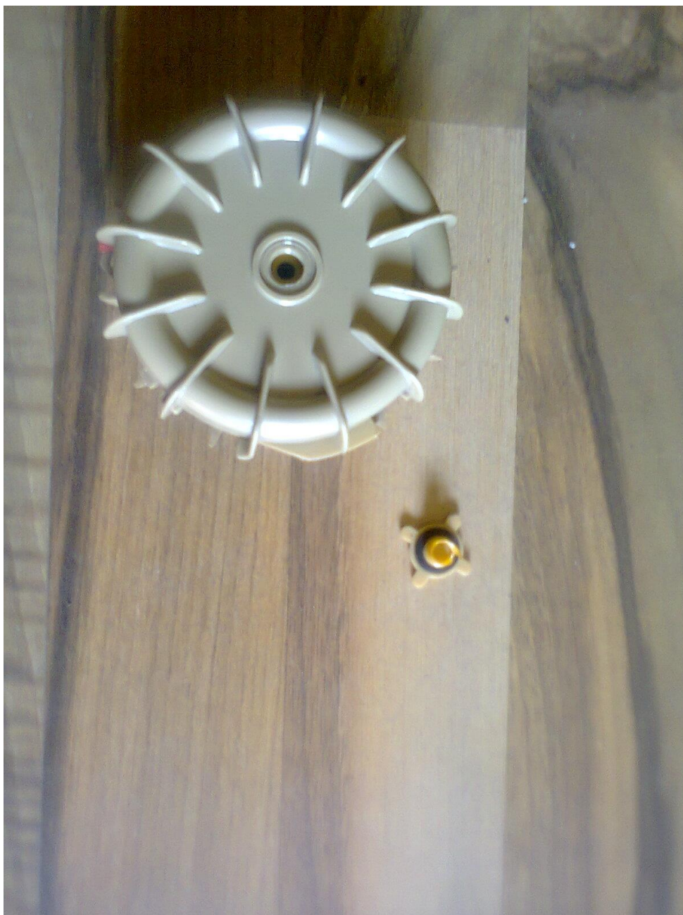
Нижняя часть итальянской противопехотной мины фугасного действия VS-50. Фото Найден Илиев
